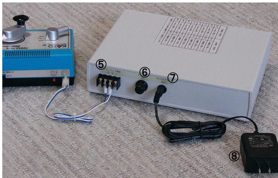
**【装置とレールとの接続方法】** : 反時計回りに列車が走行するときにATCが働く接続方法です。
